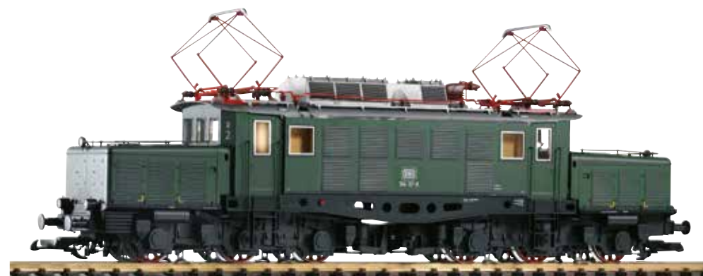
37435 E-Lok BR 194 DB Ep. IV, gealtert mit modifiziertem Antrieb DB IV BR194 Crocodile Electric Weathered with modified drive unit
