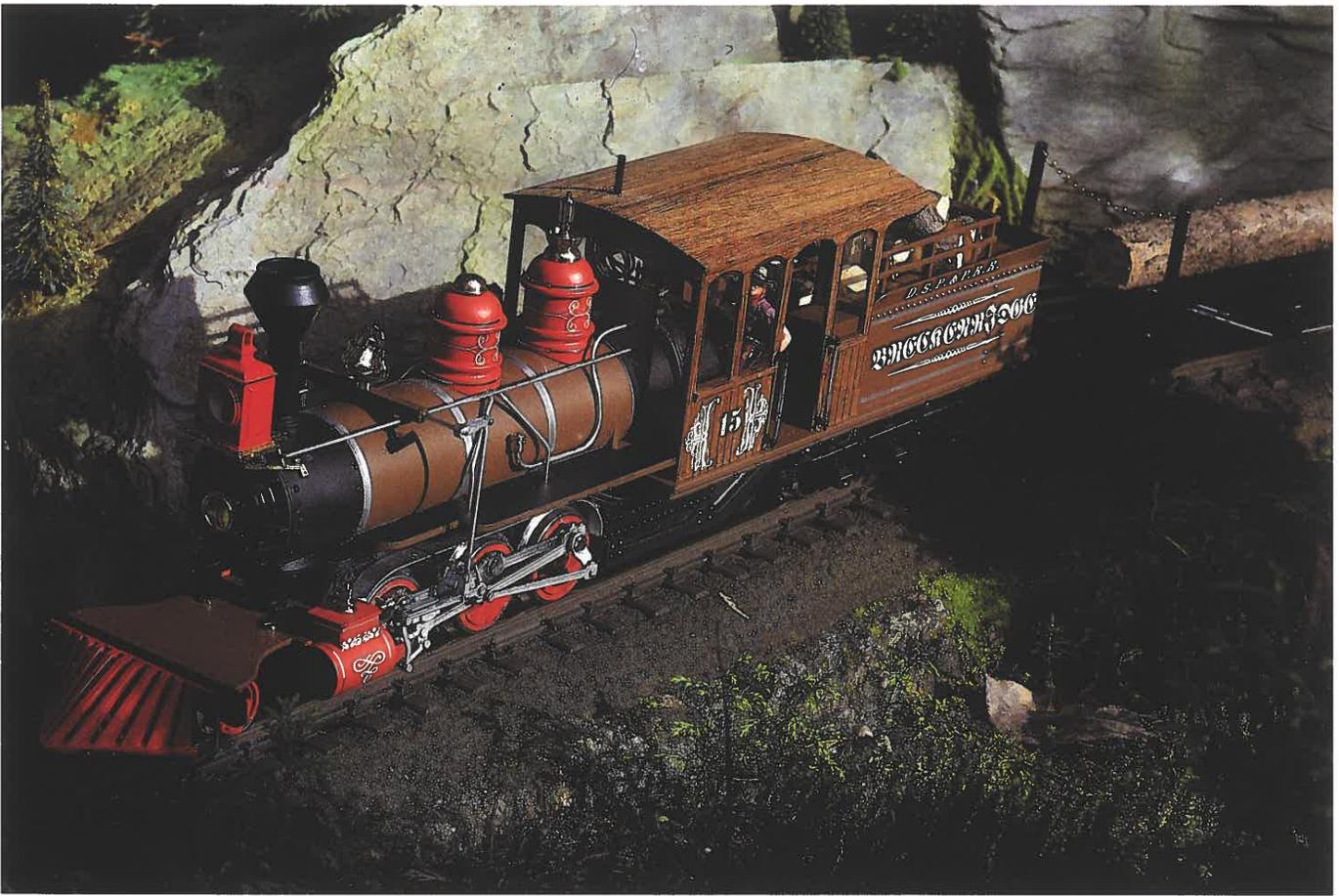
Mason Bogey-Lok "Breckenridge", bei der Lok und Tender auf einem Rahmen liegen, der unter dem Tender auf einem zweiachsigen Drehgestell ruht.
