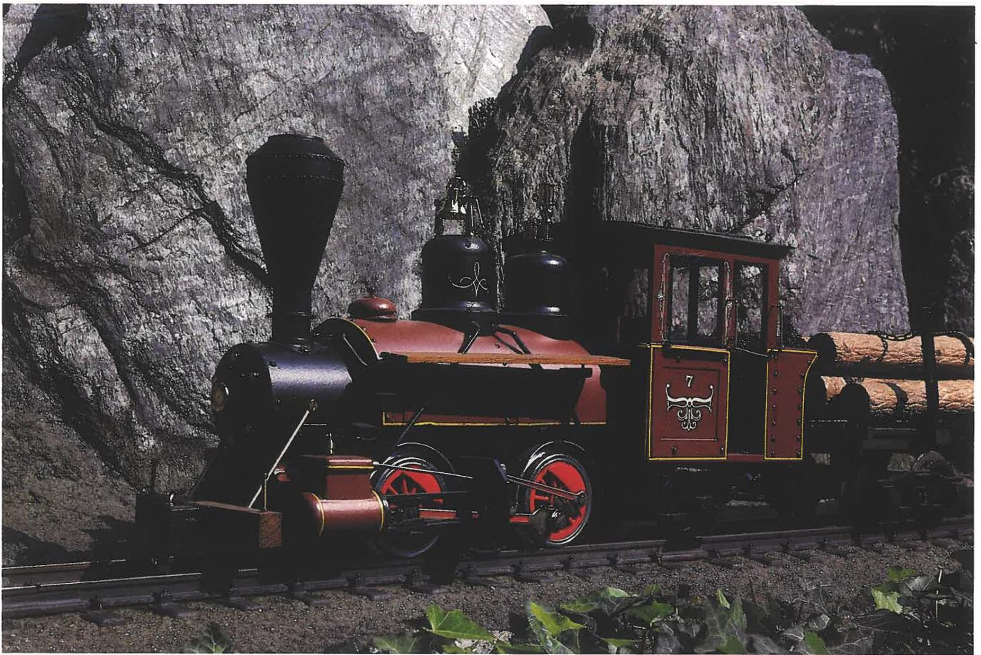
Lokomotive 7 einer Zuckerrohrplantage auf einer der hawaiianischen Inseln. Um die Achslast zu verringern, montierte man unter dem Führerhaus der zweiachsigen Tenderlok eine zusätzliche Laufachse.
